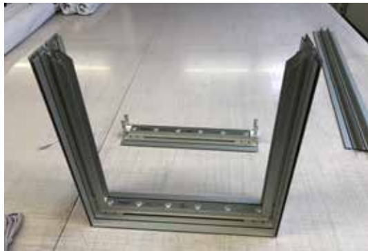
5. Eckwinkel einstecken (Schrauben müssen bündig sein) Rahmen zusammenstecken
