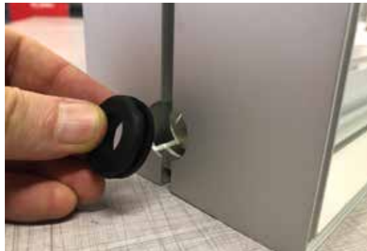
6. Gummitülle für Stromzuleitung einsetzen. LED-BOX darf nur mit Gumitülle in Betrieb genommen werden
