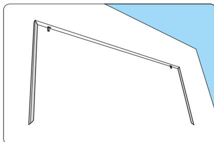
Beide Seitenprofile montieren.
