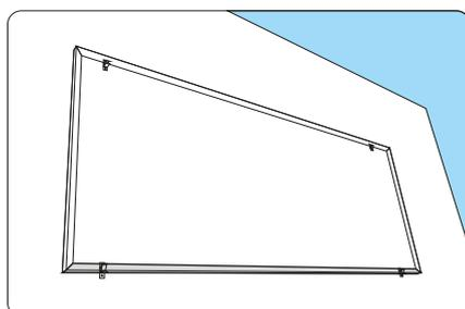
Zuletzt unteres TRIFLEX Profil einsetzen und befestigen.
